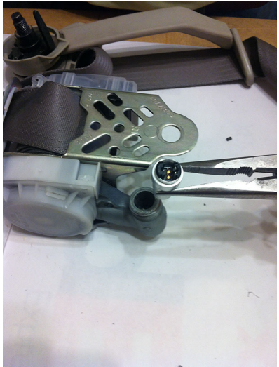
Igniter installation 029.jpg
