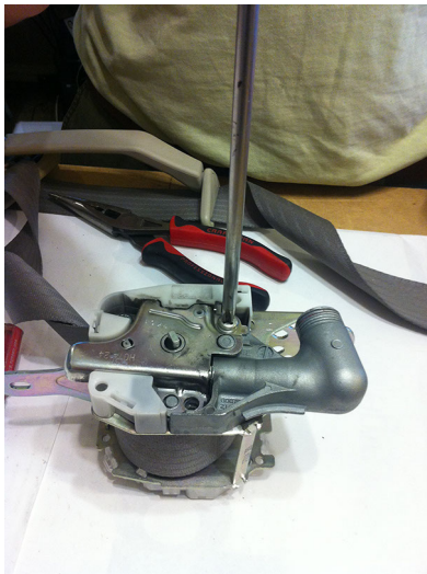
Igniter installation 023.jpg
